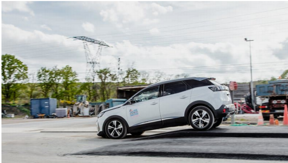
Un Peugeot 3008 avec le moteur essence 1,2 litre de 130 chevaux faisait partie du protocole de tests pour évaluer l'effet "surconsommation" des ralentisseurs. - Ligue de défense des conducteurs
