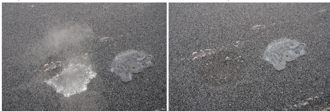
Probееinbau Niederscherli, Versuch mit reinem Wasser (rechts) und Seifenwasser (links)
