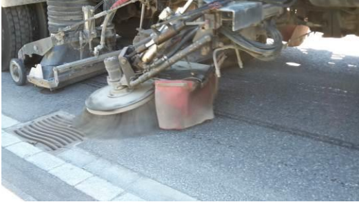
Abb. 13 Reinigungsverfahren kehren mit anschliessendem Absaugen.
