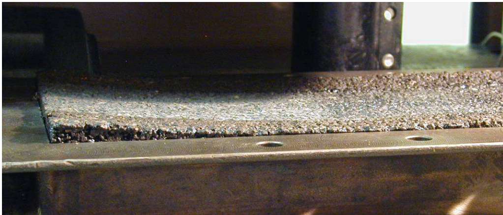
Fig. 16 Phénomène de soulèvement des plaques avec une épaisseur de 20 mm.
