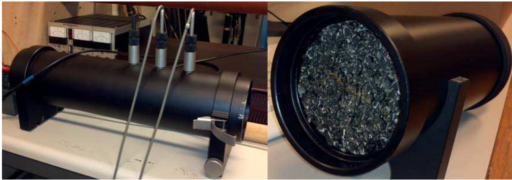
Fig. 18 Photographie du tube d'impédance et de son porte-échantillon.
