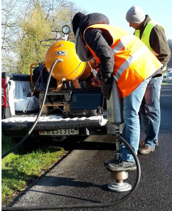
Abb. 9: Luftpermeabilitätsverfahren entwickelt von Weibel AG.
