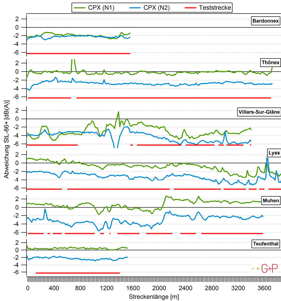
Abb. 1: Streckenverlauf der CPX-Messungen für PW (N1; blau) und LKW (N2; grün). Die Teststrecke (rot) zeigt die Daten, welche unbeeinflusst von Schachtdeckeln, Fussgängerstreifen, sonstige Markierungen oder Kreisel sind und in die Auswertung mit eingeflossen sind.
