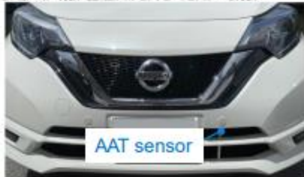
マトリクス赤外線センサーはフロントバンパー裏側に取り付けられている
