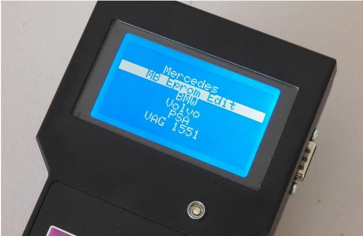
*„Es konnten keinerlei Hinweise gefunden werden, dass mit Geräten zur Tacho-Manipulation ein gefälschter Kilometerstand erkennbar ist. (...) Vielmehr sind die untersuchten Geräte ausschließlich für die Veränderung von Wegstrecken-Zählern in Kfz-Steuergeräten bestimmt.“*
