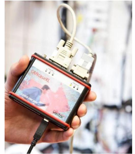
Aufzeichnung der elektrischen Signale zwischen Manipulationsgerät und Auto mit „CANcaseXL“ u.a.
