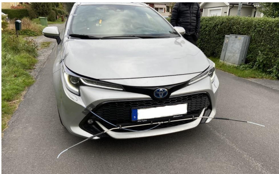
Figur 11. Mätprob för plume chasing monterad i fronten på en personbil.
