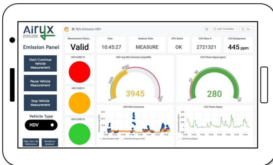
Figur 13. Webbgränssnitt för plume chasing-instrument.
