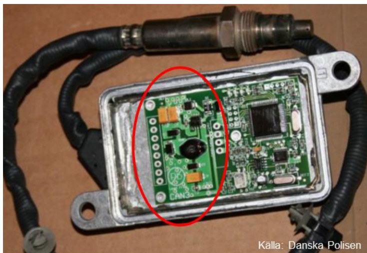
Figur 7. Emulator gömd i kontrollenhet till kväveoxidsensor för att manipulera sensorns signaler och lura styrdatorn.
