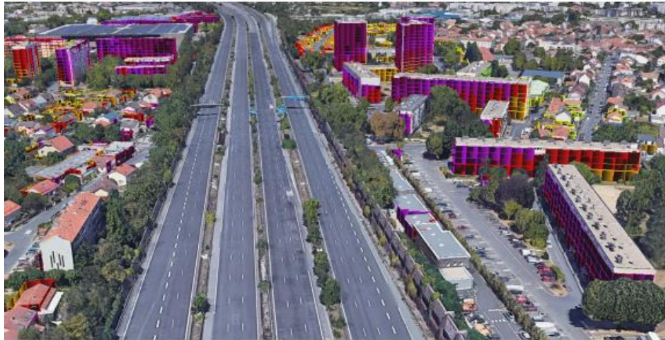
Figure 3 : Cartographie du niveau sonore (selon l'indicateur Lden) généré par l'autoroute A6 en façade des bâtiments de l'Hay-les-Roses avant la pose du revêtement antibruit
