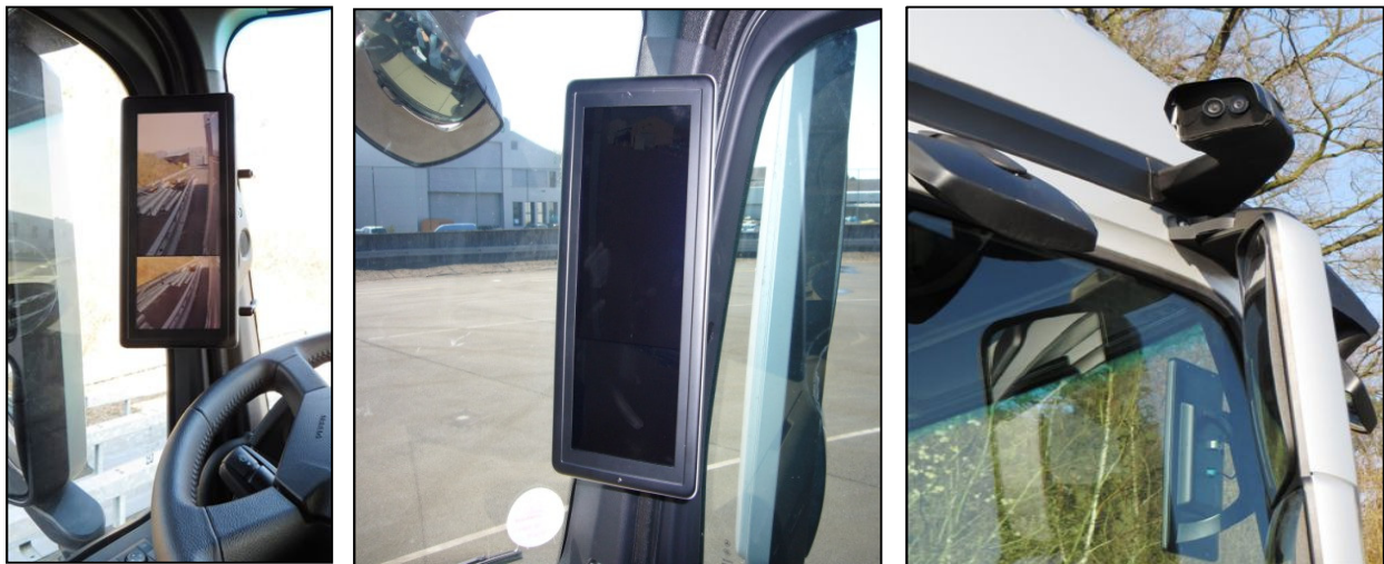
Abbildung 2: Monitor- und Kameraintegration im prototypisch nachgerüsteten Lkw
