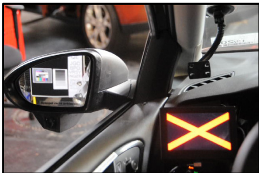
Abbildung 5: Bildausfall durch elektromagnetische Strahlung
