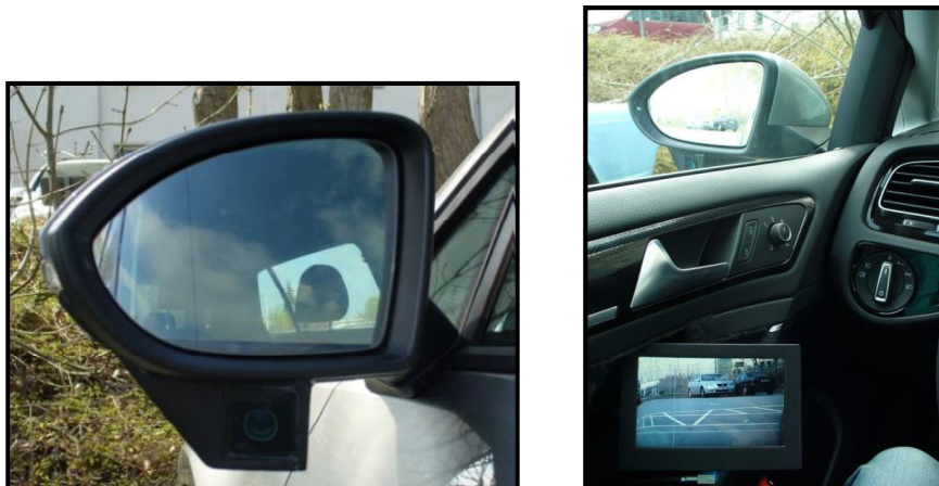
Abbildung 1: Kamera- und Monitorintegration (eine der gewählten Positionen) im nachgerüsteten Pkw auf der Fahrerseite
